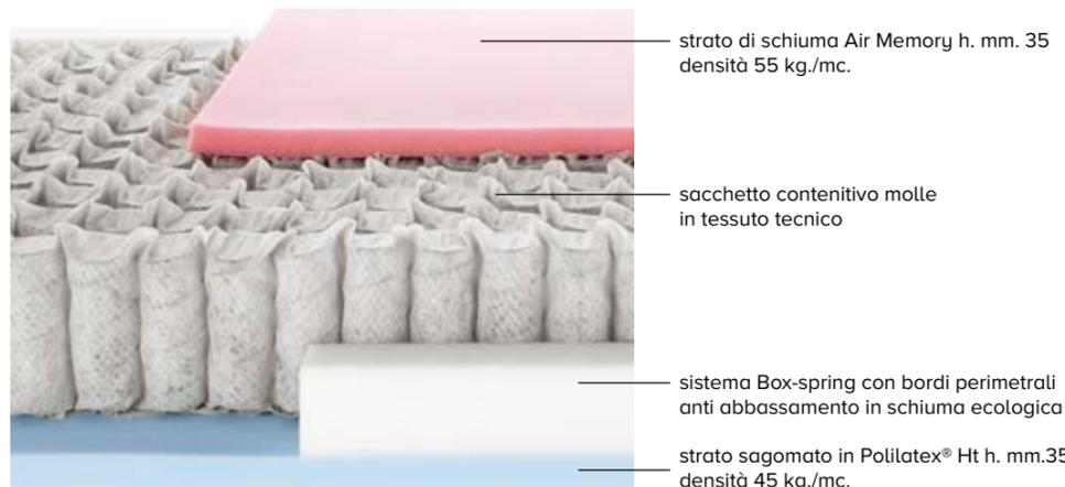
Accademy ha il secondo lato in Polilatex® Ht, schiuma espansa di nuova generazione, realizzata attraverso processi produttivi dagli standard molto elevati, in grado di conferirle elevata porosità. Resiste bene al calore e all'umidità, principali cause di invecchiamento e perdita di resilienza delle schiume poliuretatiche più comuni.
